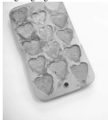
Gambar 2. Mencetak semen dengan cetakan karet (Sumber: buzzfeed.com)
